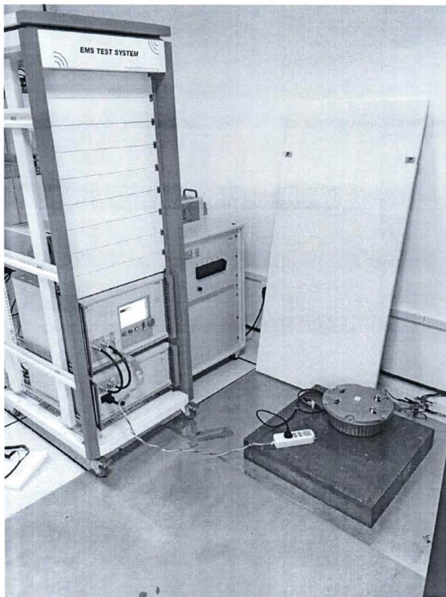
图 16 浪涌抗扰度 被测设备的连接图
